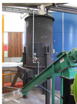
200 kW updraft gasifier
